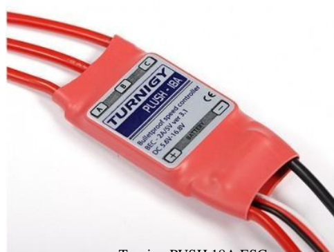
Turnigy PUSH 18A ESC
